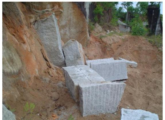
Figuras 5 a 8: Aspectos do trabalho manual no corte de blocos do Granito Pingo de Ouro, pedreira no interior de Sertão Santana.
