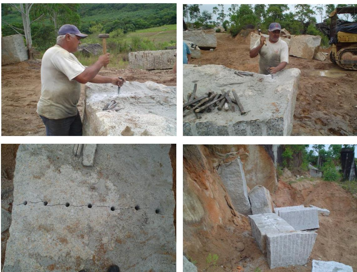
**Figuras 09 a 12:** Aspectos do trabalho manual no corte de blocos do Granito Pingo de Ouro, pedreira no interior de Sertão Santana.
